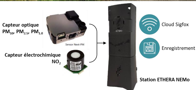
Figure 2. Station ETHERA NEMO pour la surveillance de la qualité de l'air ambiant et capteurs NO 2 et PM
